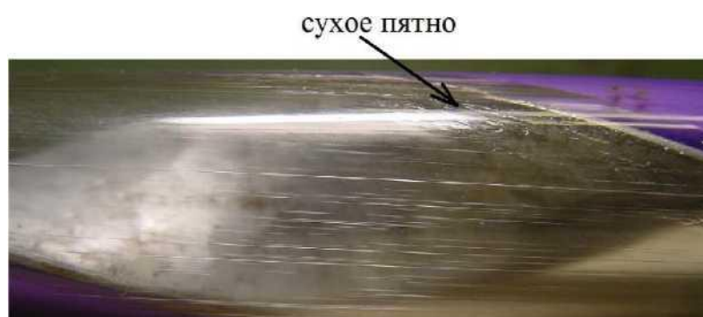
Рисунок . 9.3 - Фотография неполного кольцевого режима течения
