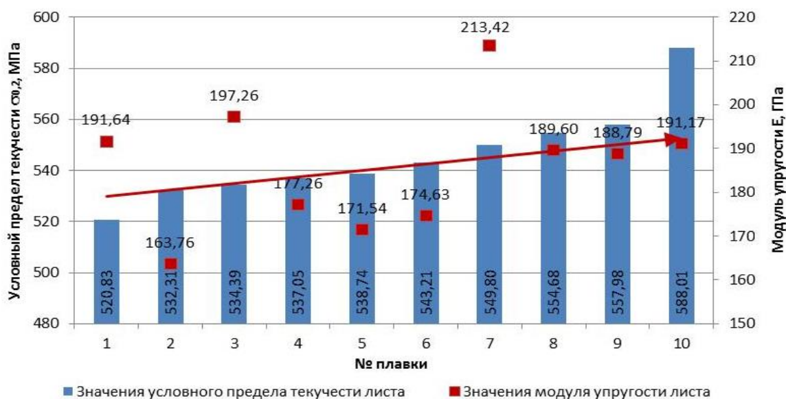
Рисунок 10 – График исходных механических свойств листового проката
