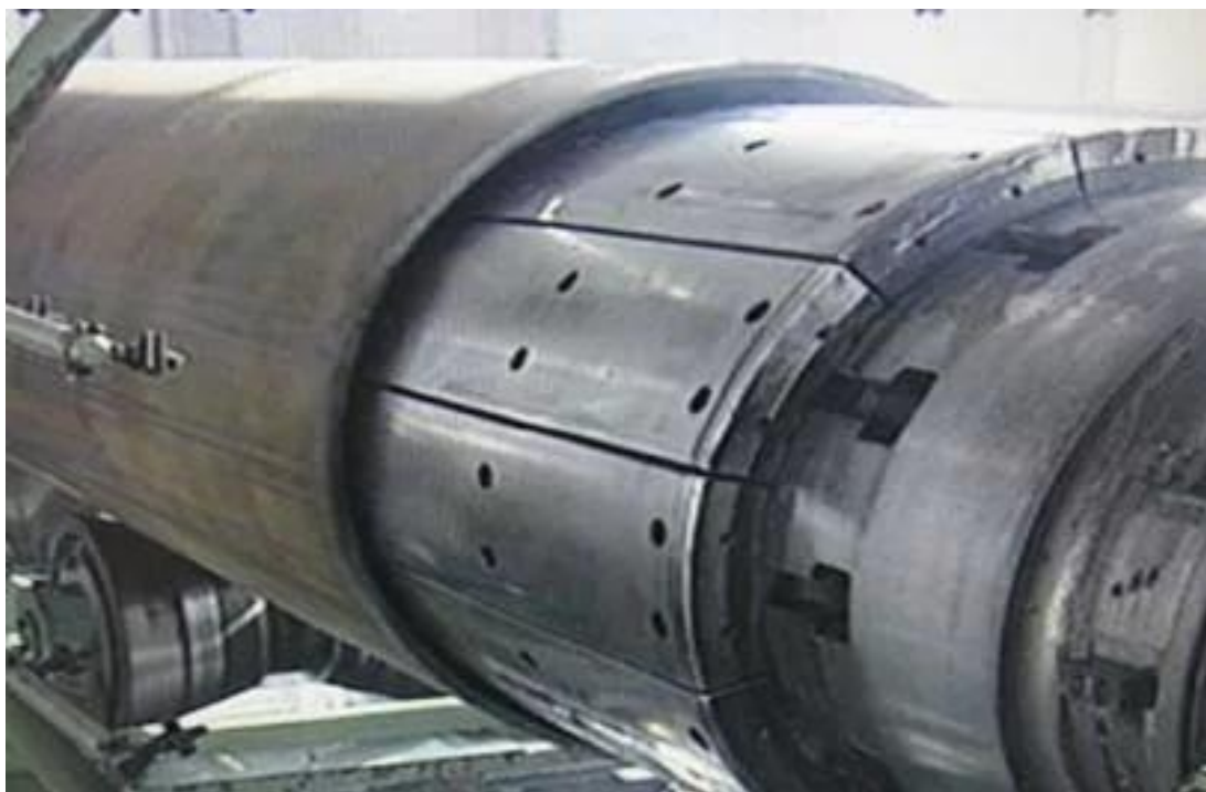
Рисунок 9 – Калибровочная часть пресса-расширителя
