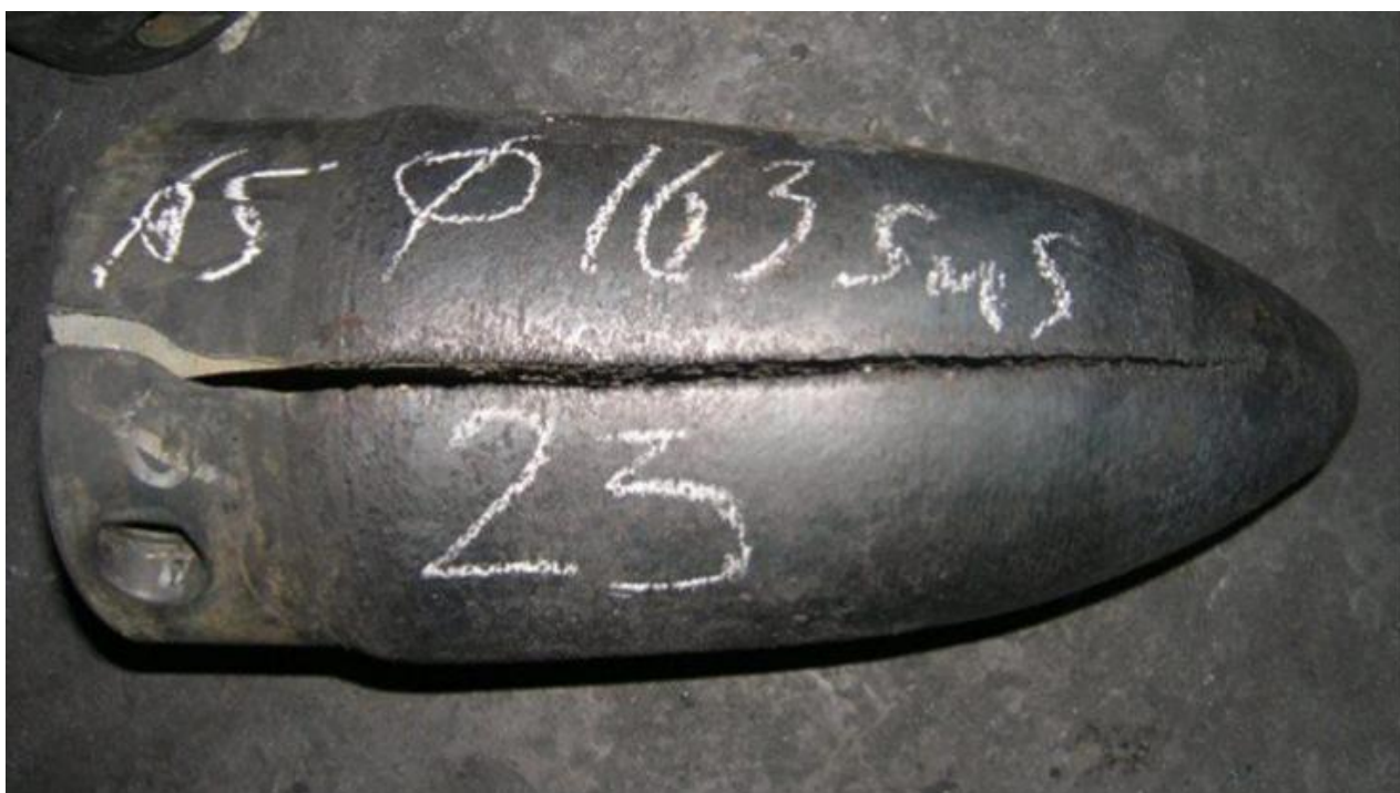
Рисунок 11 – Трещины на поверхности оправки
