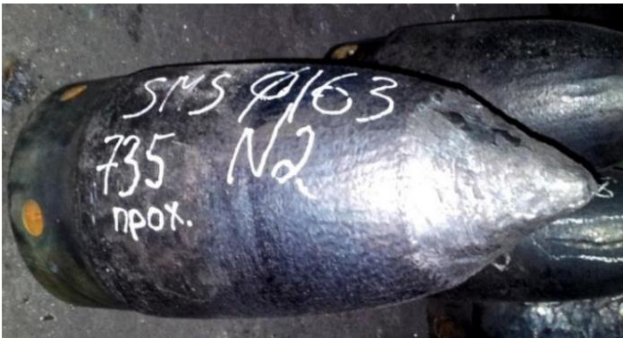
Рисунок 9 – Деформация носка и рабочей поверхности оправки
