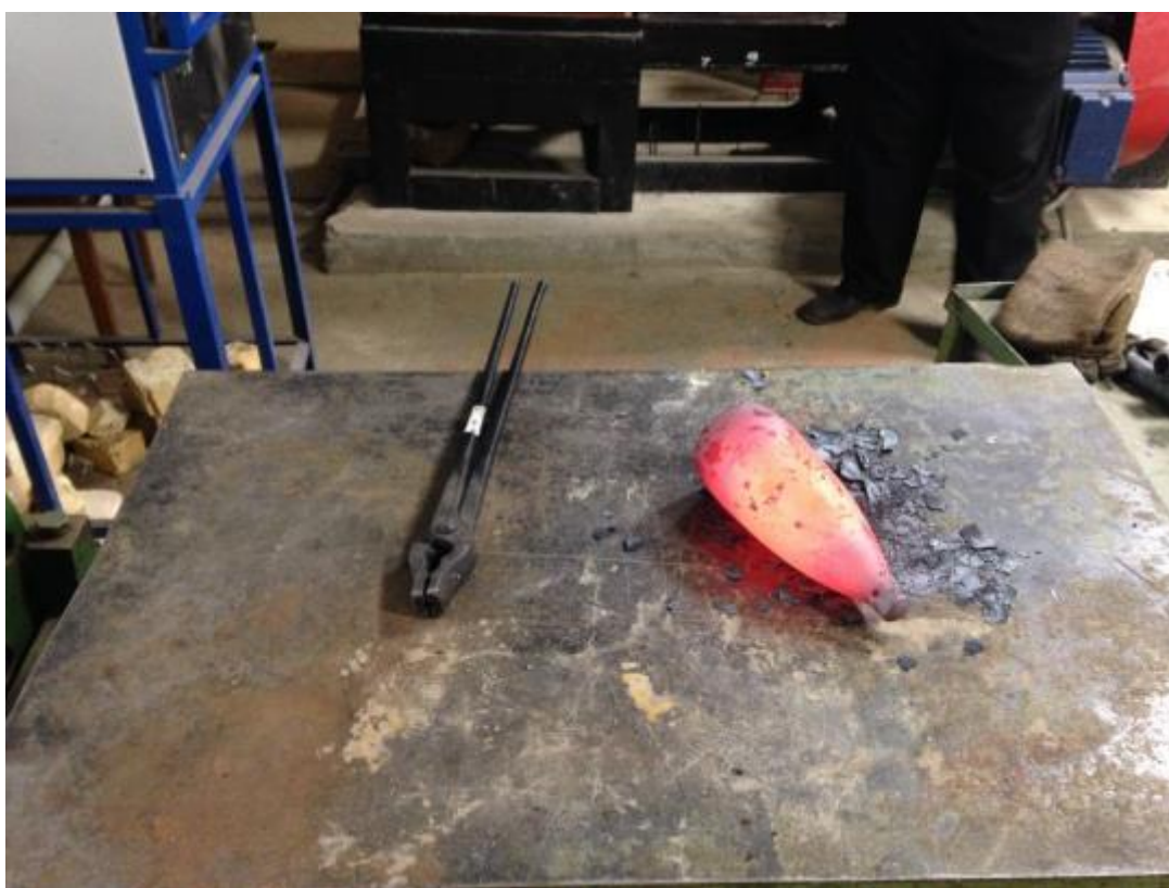
Рисунок 21 – Нагретая оправка во время процесса охлаждения
