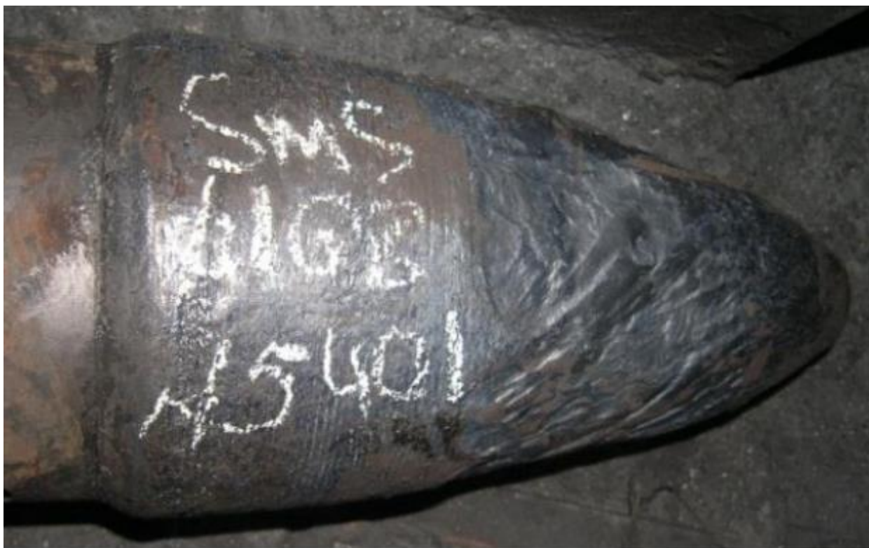
Рисунок 10 – Местная выработка, истирания, задиры и вырывы металла из тела оправки
