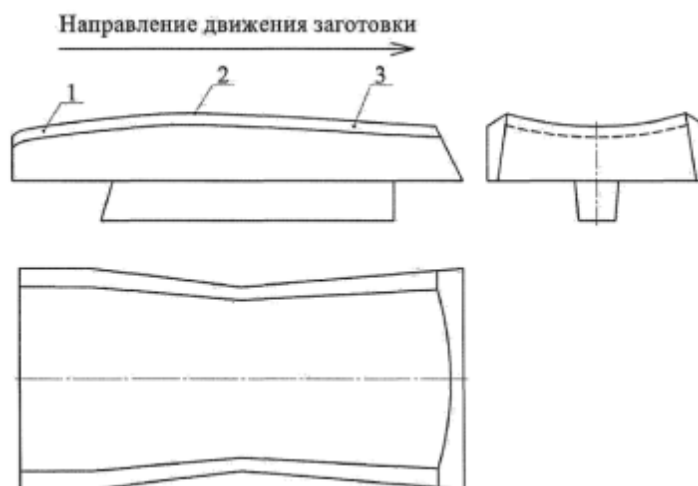
Рисунок 7 – Линейка прошивного стана: 1 – входная сторона; 2 – гребень; 3 – выходная сторона
