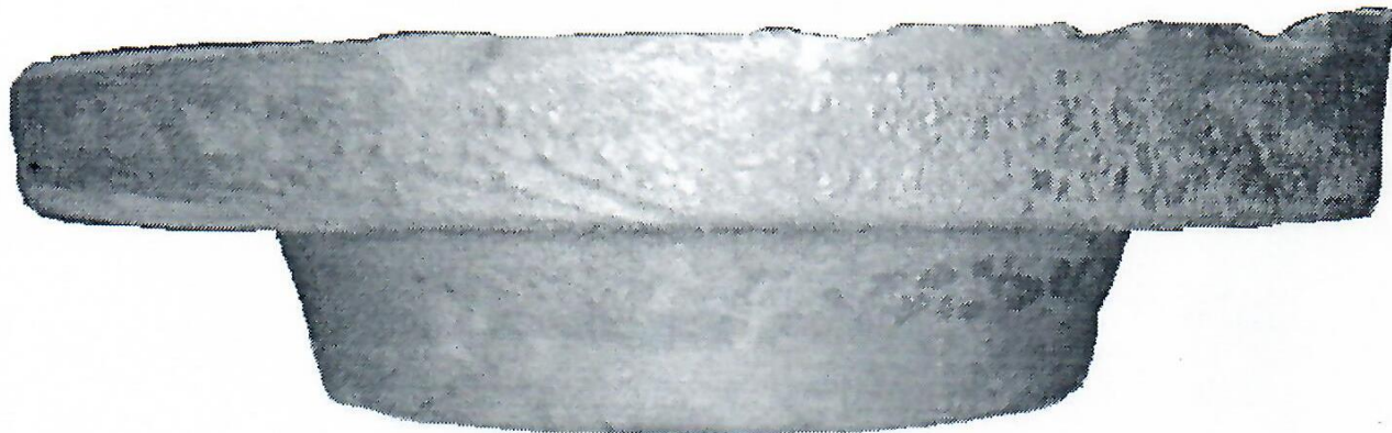
Рисунок 1.1 – Поковка фланца (брак)
