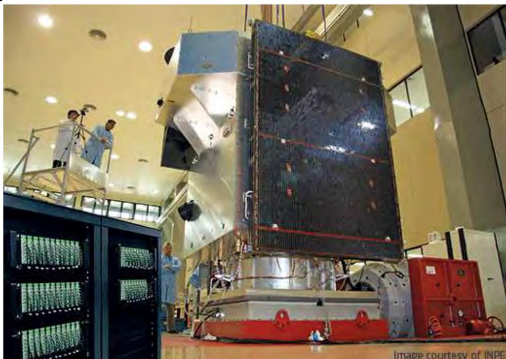
Рисунок 4- Проведение виброиспытаний спутника
