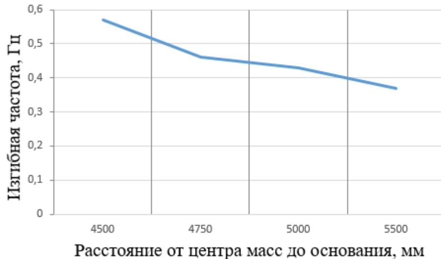
График 3 – Зависимость частоты изгибных колебаний системы при изменении расстояния центра масс до основания
