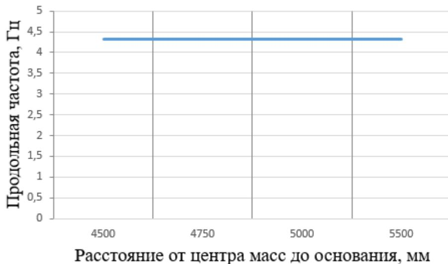
График 4 – Зависимость частоты продольных колебаний системы при изменении расстояния центра масс до основания
