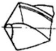
Рисунок 3.10 – Форма заточки сверла
