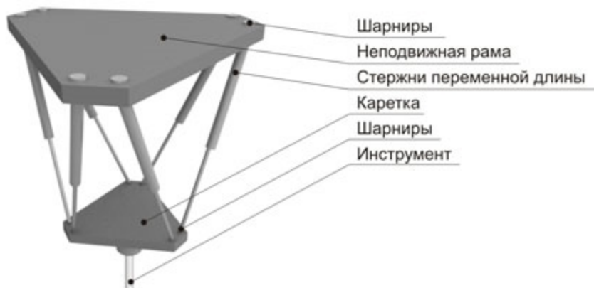
Рисунок 15 - Схема конструкции КИМ-750 «ЛАПИК» и ее двухрамной конструкции.
