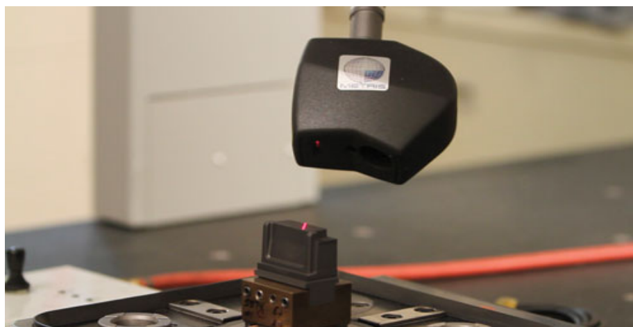
Рисунок 19 - Представитель группы измерительных лазерных сканеров в работе
