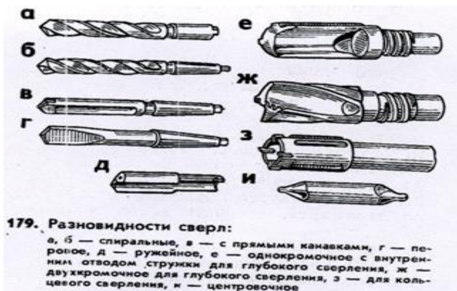
Рисунок 2.14 - Разновидности сверл
