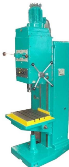
Рисунок 27 – 2H135 станок вертикально-сверлильный универсальный одношпиндельный.
