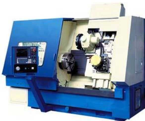
Рисунок 25 – 1П756ДФ3 Станок токарный патронный с ЧПУ, полуавтомат
