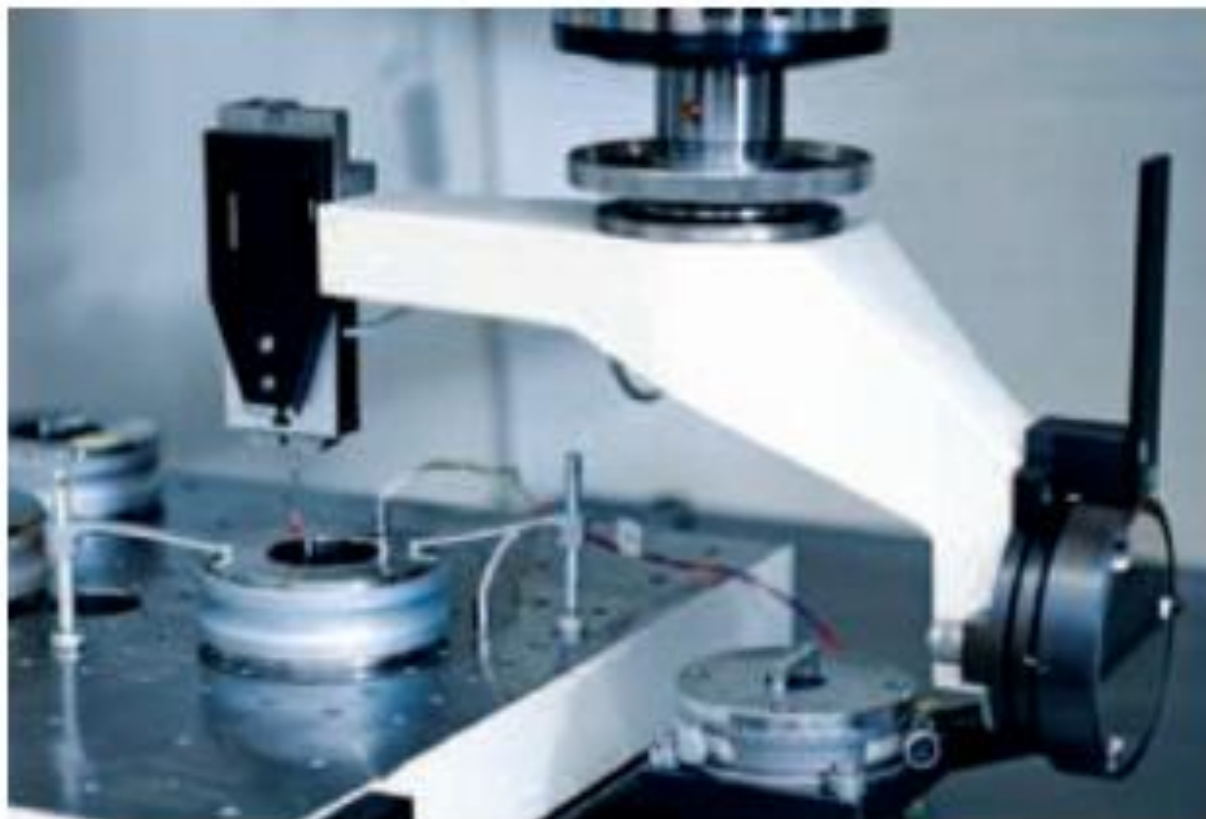
Рисунок 1.8 – Патрон машины SIP LMM5 с контактным измерительным щупом [15]
