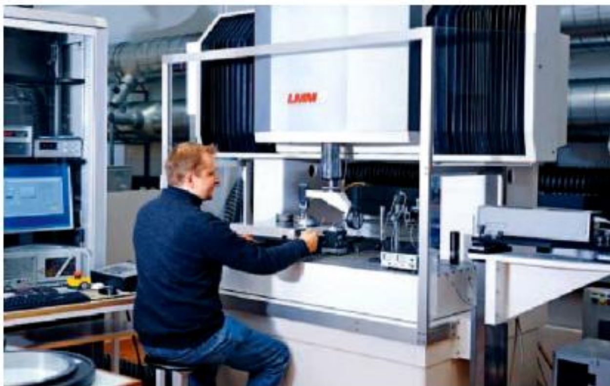
Рисунок 1.7 – Машина для измерений длины SIP LMM5, METAS, Швейцария [15]
