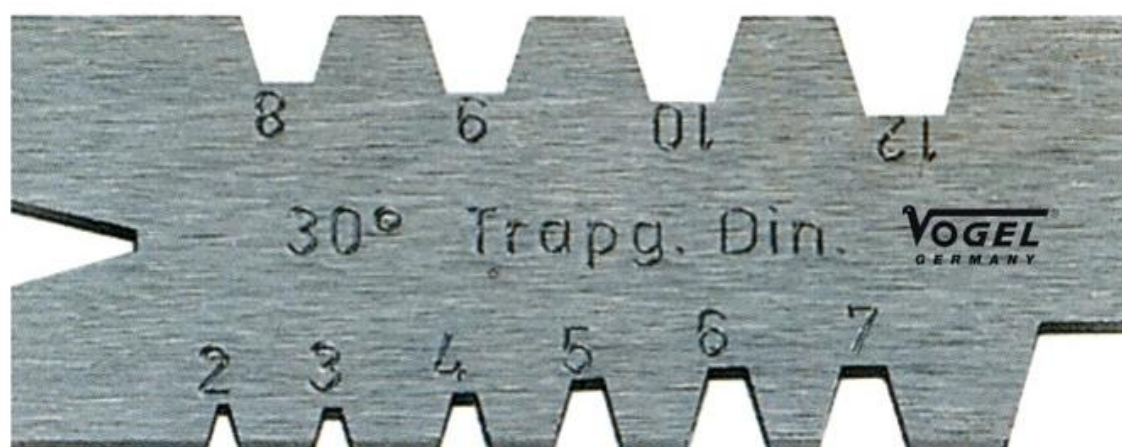
Рисунок 1.4 – Комбинированный шаблон для контроля метрической и дюймовых резьбовых поверхностей [14]
