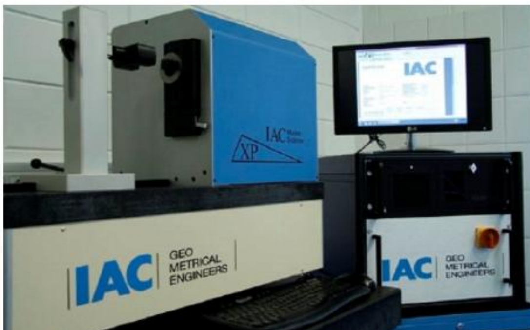
Рисунок 1.15 – Общий вид измерителя параметров резьбовых и гладких калибров MasterScanner [15]
