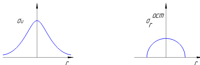
Рисунок 2.6 – Распределение напряжений в области отпечатка
