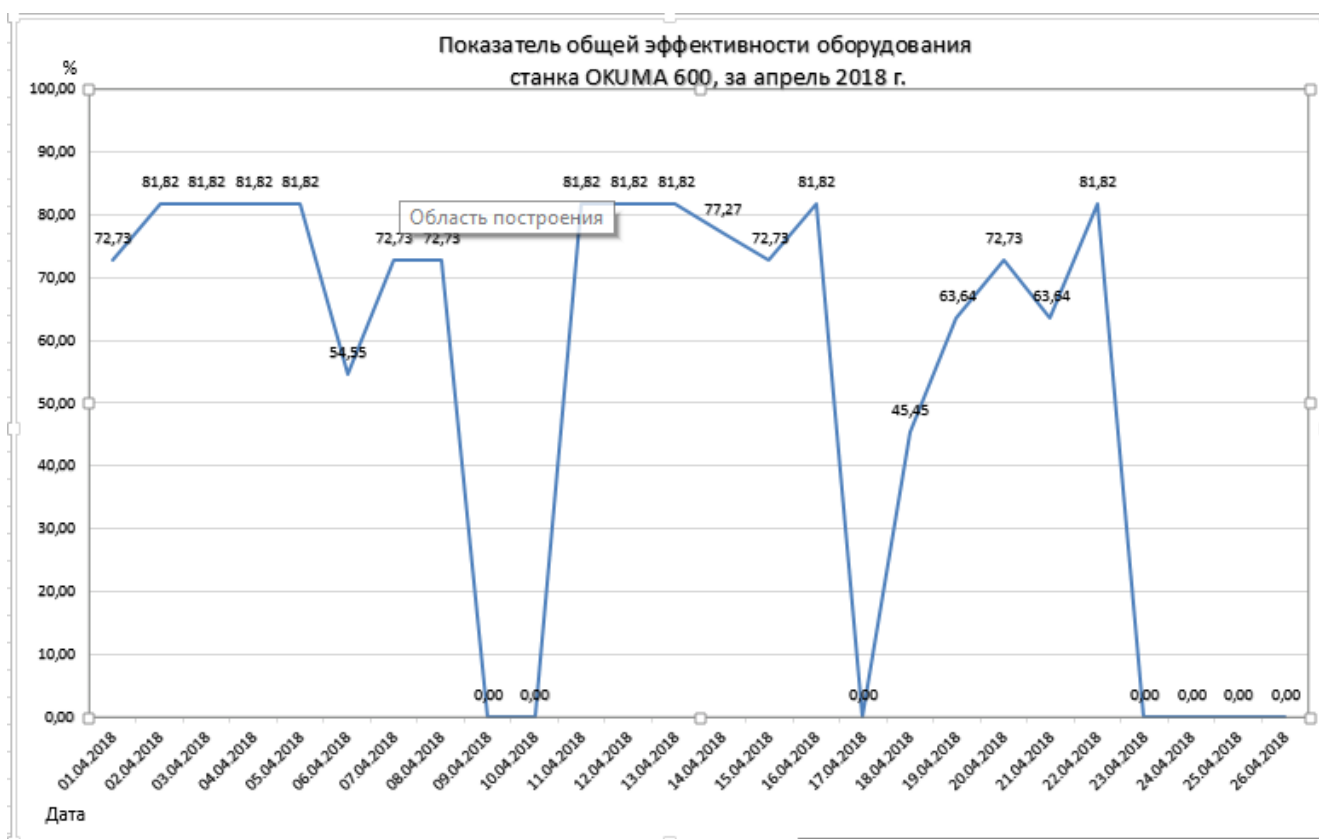
Рисунок 9 – График общей эффективности оборудования для станка OKUMA 600 за апрель 2018 г.
