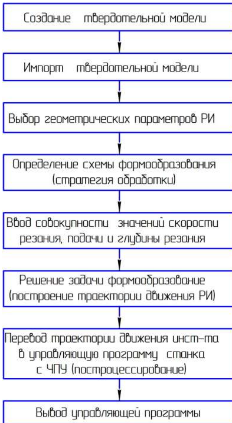
Рисунок 2.1 – Типовой порядок расчета управляющей программы станков с ЧПУ в PowerMill
