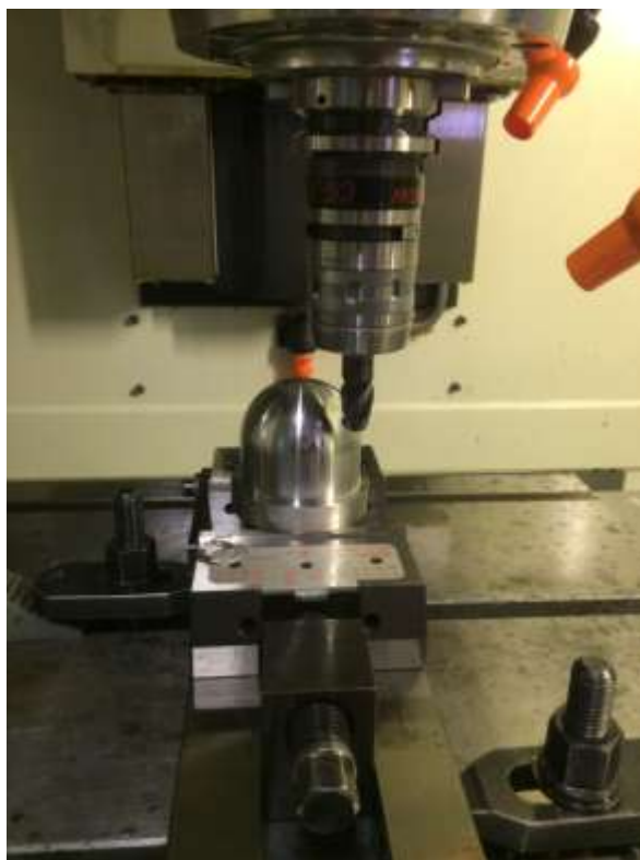
Рисунок 4.24 — Заготовка в приспособлении до обработки
