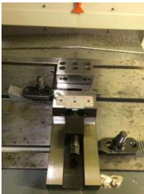
Рисунок 4.5 – Механические прецизионные тиски серии «ТС» фирмы OML
