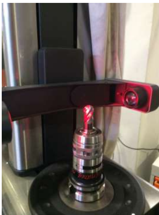
Рисунок 4.3 – Инструмент в цанговом патроне
