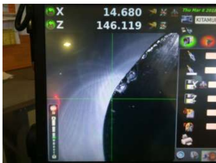
Рисунок 4.16 – Координаты произвольной точки третьего участка относительно державки до обработки
