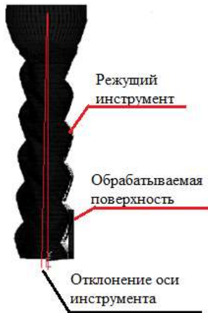
Рисунок 1.7 – Изменение положение режущего инструмента в процессе фрезерования [14]
