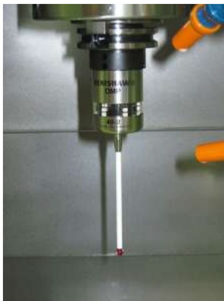
Рисунок 4.8 – Датчик OMP40-2 Renishaw
