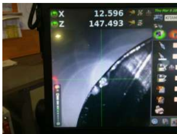
Рисунок 4.14 – Координаты произвольной точки второго участка относительно державки до обработки
