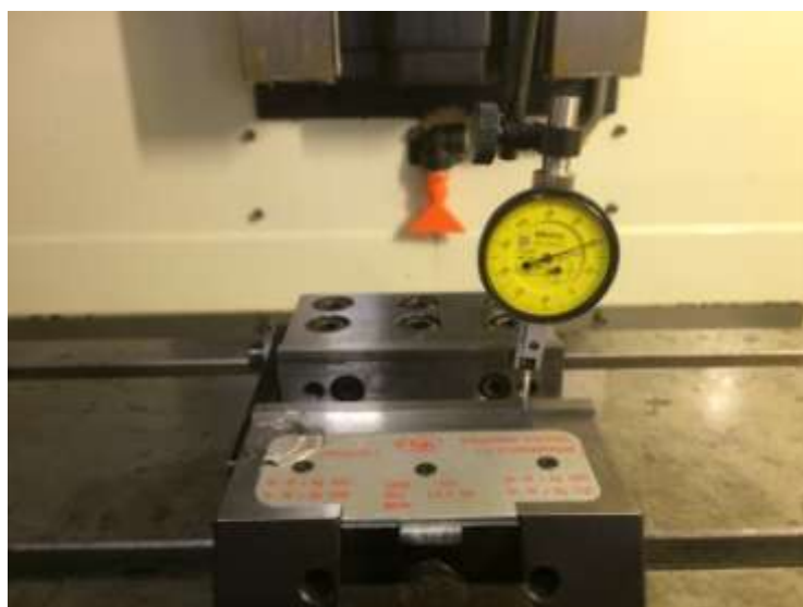
Рисунок 4.23 – Конечное положение индикатора при движении по оси X
