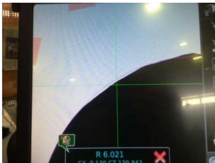
Рисунок 4.10 – Значения радиуса инструмента на приборе настройки инструмента вне станка
