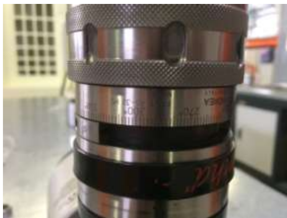
Рисунок 4.2 – Высокоточный цанговый патрон для зажима инструмента
