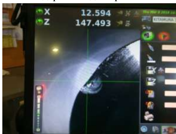
Рисунок 4.15 – Координаты произвольной точки второго участка относительно державки после прохождения 400 мм
