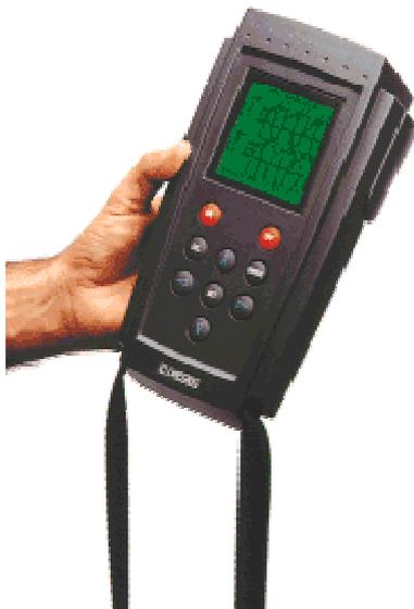
Портативный прибор для регистрации параметров трехфазных и однофазных сетей 220/380 В или высоковольтных сетей (при наличии измерительных трансформаторов)
