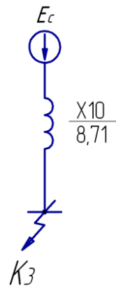
Рисунок 6.3 – Схема замещения для расчета КЗ в точке К 3
