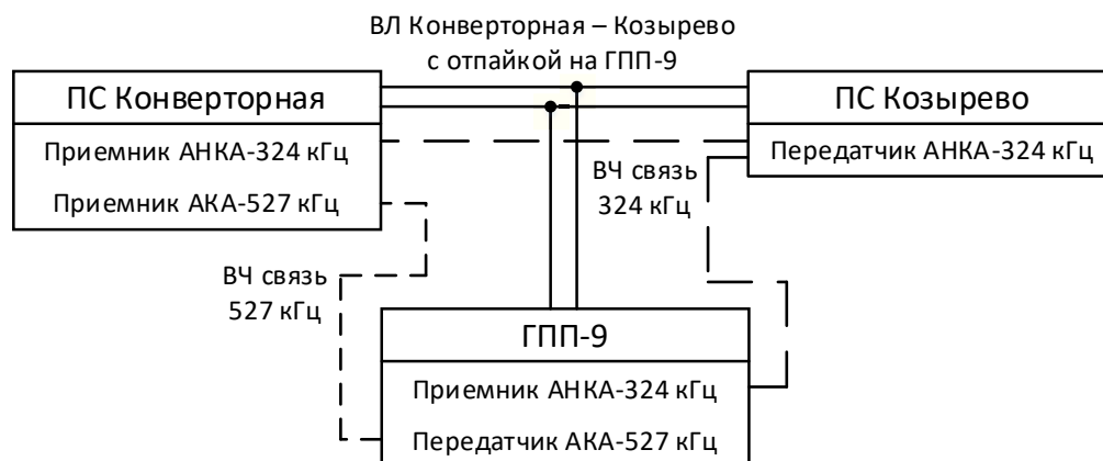
Рисунок 6.1 – Высокочастотная связь между подстанциями
