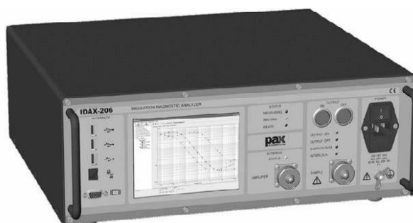
Рисунок 2.7 – Диагностика изоляции трансформаторов
