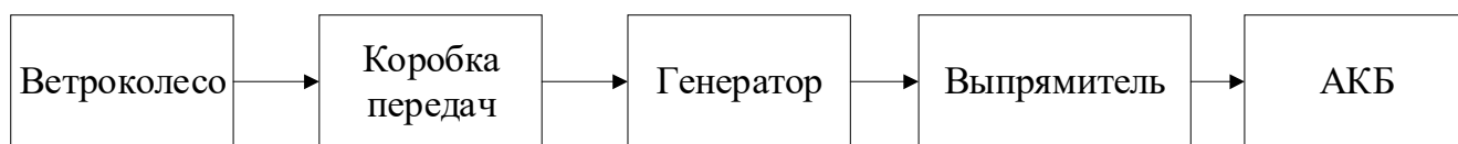
Рисунок 1.11 – Схема системы с коробкой передач (редуктором)
