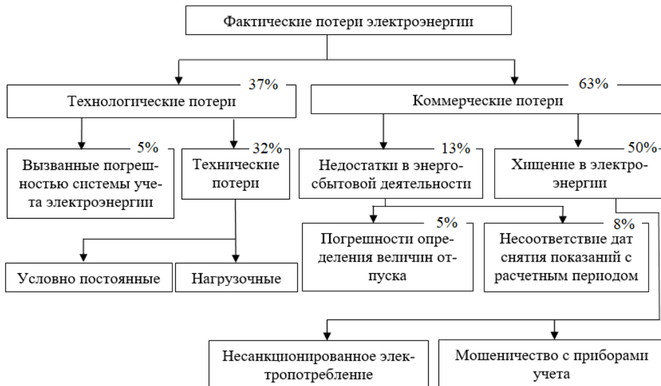
Рисунок 2.1 – Структурная схема потерь
