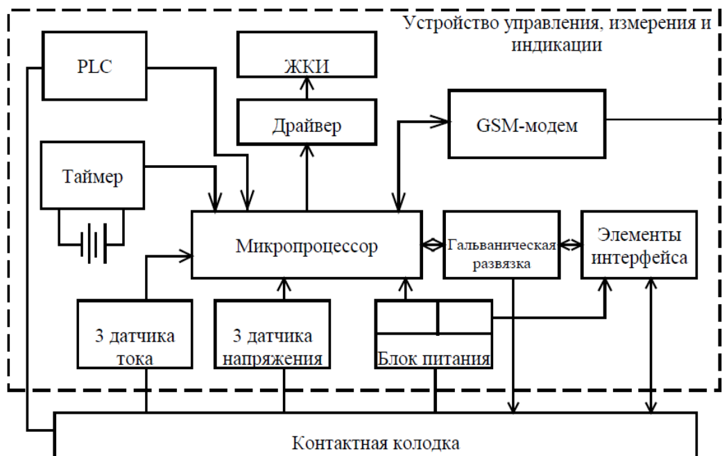
Рисунок 4.2 – Структурная схема счетчика СЕ 303
