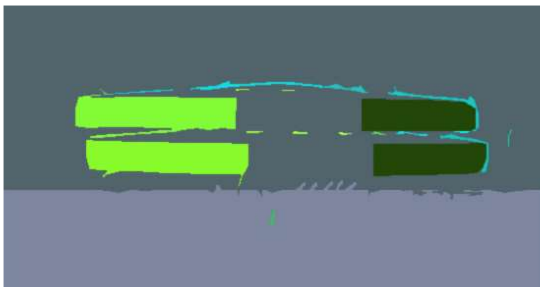
Рисунок 3.16 – Взаимодействие потоков жидкости при использовании двух дисков. Расстояние 10 мм.
