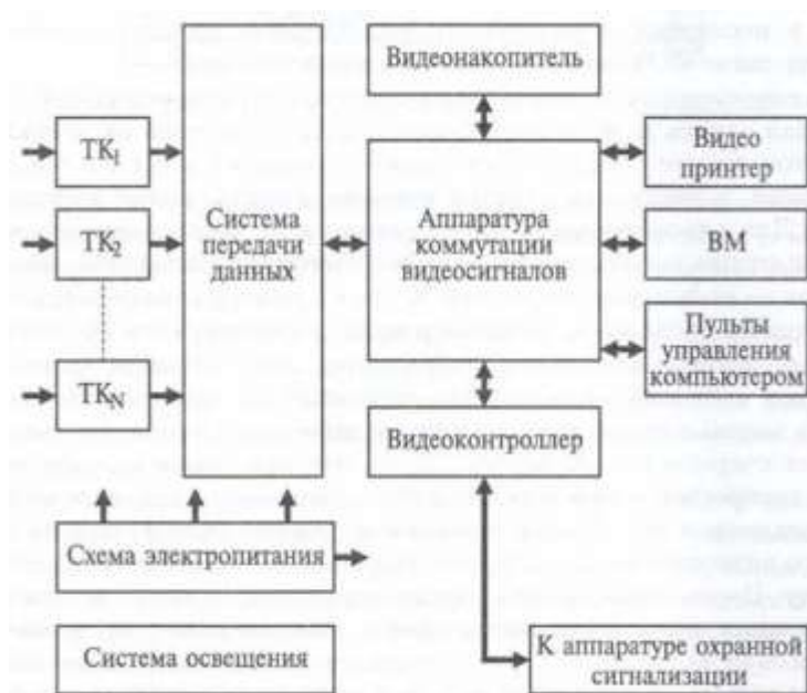
Рисунок 2.2 – Типовая структурная схема системы видеонаблюдения
