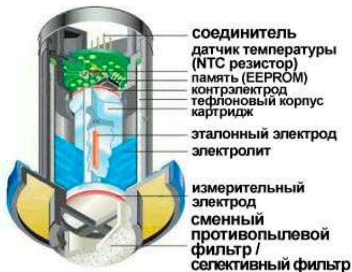
Рисунок 4 – Общий внешний вид и состав электрохимической ячейки
