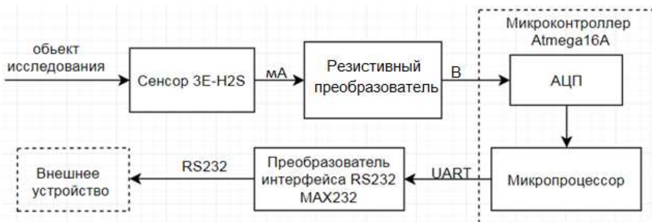
Рисунок 8– Функциональная схема ИИС
