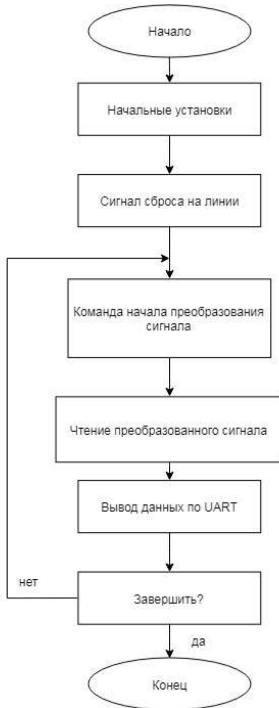
Рисунок А.1 – Алгоритм программы микроконтроллера
