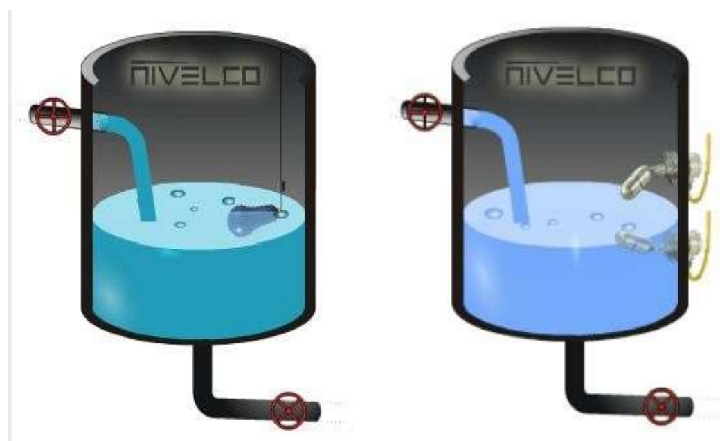
Рисунок 1.1 – Емкости с поплавковыми сигнализаторами уровня из полипропилена NivoFLOAT для питьевой воды и магнитным NivoMAG Nivelco, Венгрия [6]
