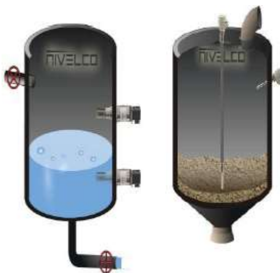
Рисунок 1.21 – Емкости с вибрационными сигнализаторами уровня Nivoswitch, производитель Nivelco, Венгрия
