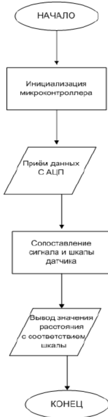
Рисунок А.1 – Блок-схема работы датчика уровня
