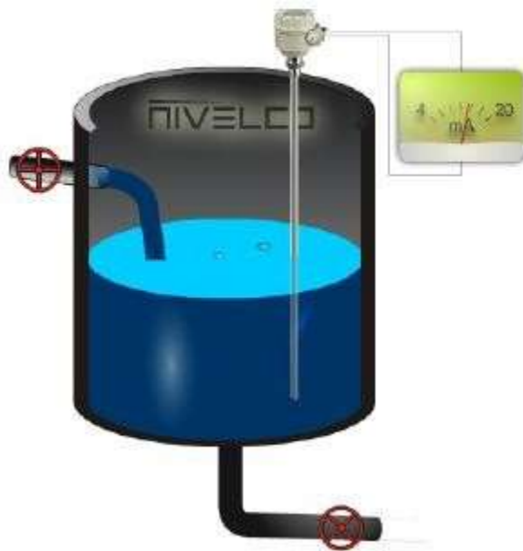
Рисунок 1.15 – Пример установки емкостного уровнемера, производитель Nivelco, Венгрия
