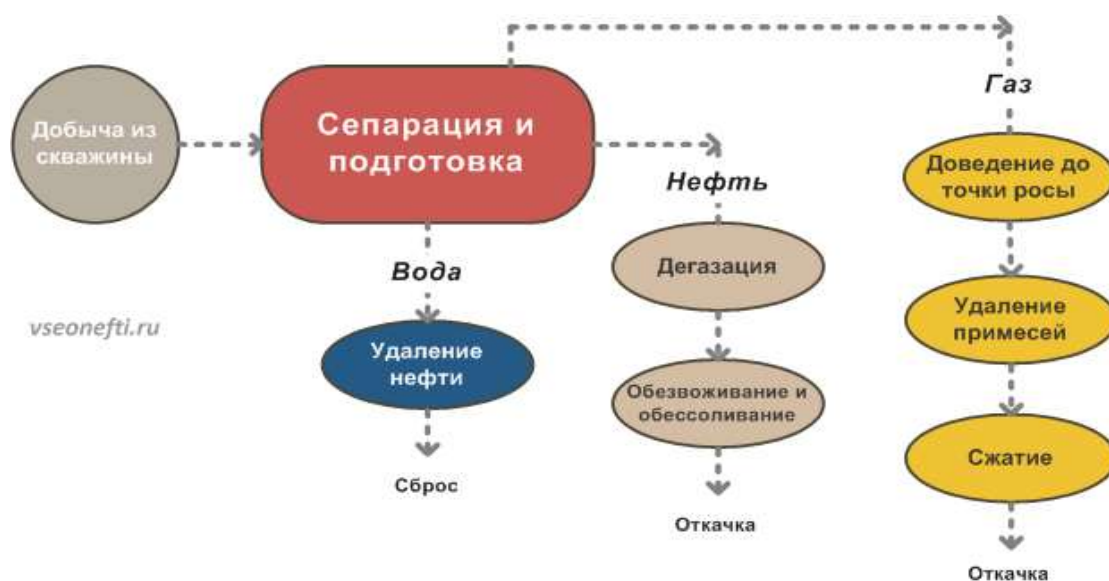
Рисунок А 1.3 – Принципиальная схема сбора и подготовки нефти
