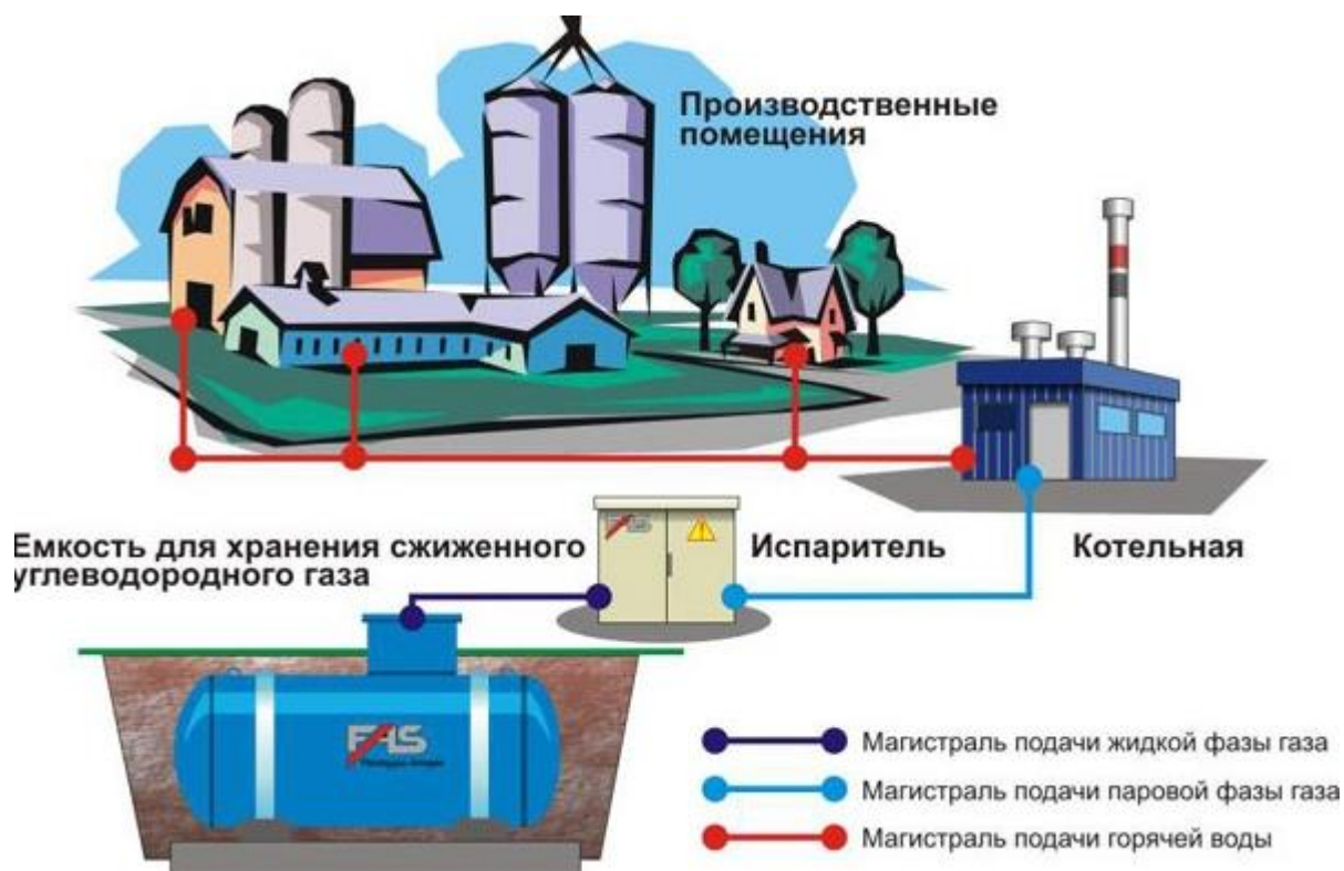
Рисунок 3.6 - Схема водяного отопления производства местной котельной
