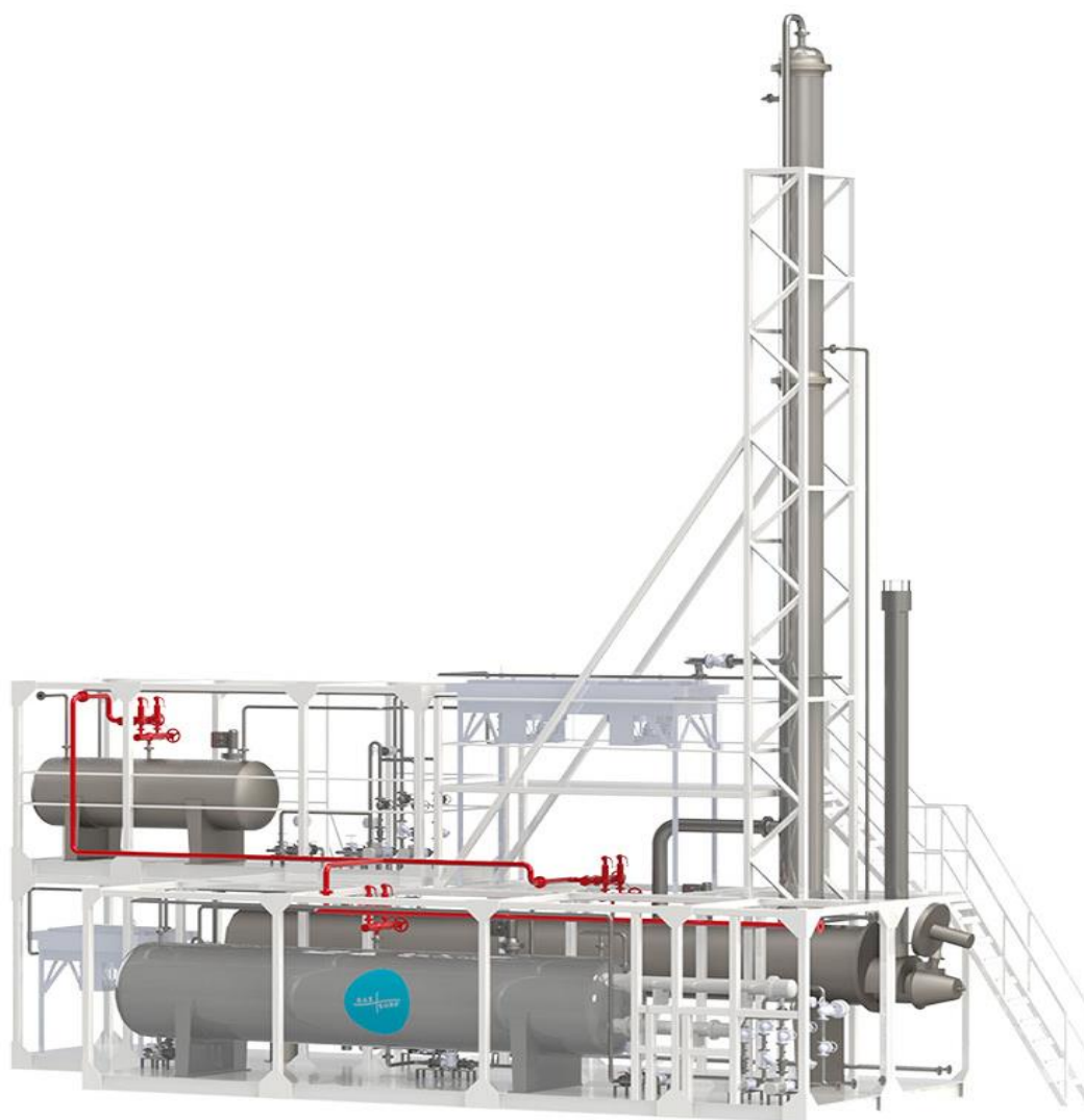
Рисунок 3.1 - Модель установки регенерации метанола
