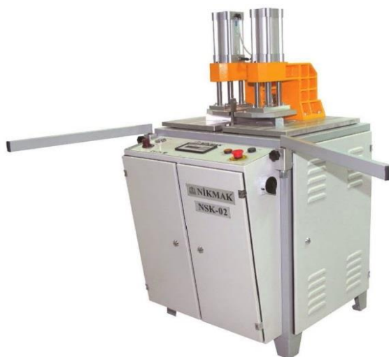
Рисунок 3.2 - Одноголовый сварочный станок NIKmak NK-02
