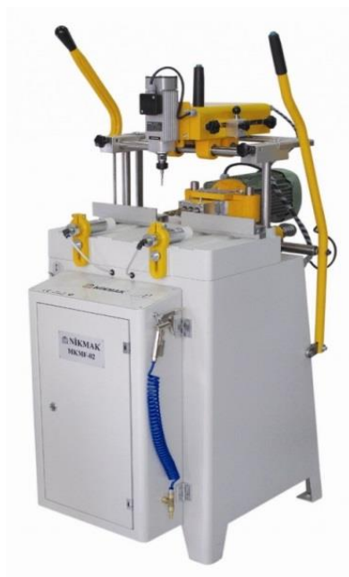
Рисунок 3.5 - Копировально-фрезерный станок Nikmak MKMF-02
