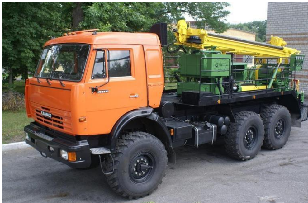
Рисунок 3.1 – Буровая установка ПБУ-2
