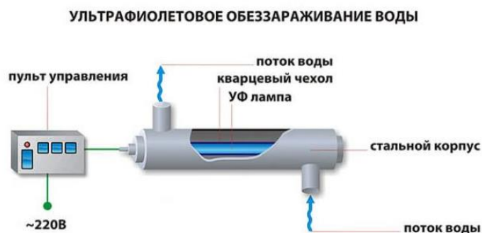
Рисунок 3.5 - Ультрафиолетовая установка для обеззараживания воды
