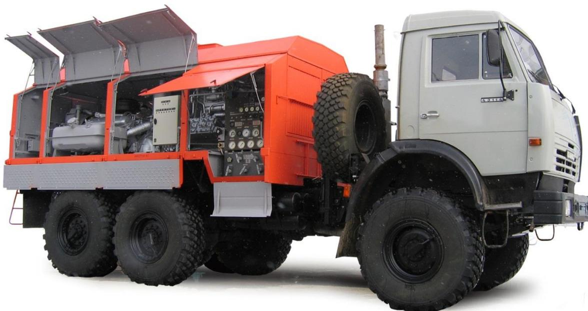
Рисунок 3.2 - Передвижная станция для приготовления и закачки кислотных композиций УДР-32М.
