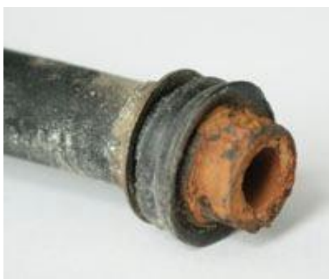
Рисунок 1.2 – Отложение соединений железа на стенках труб
