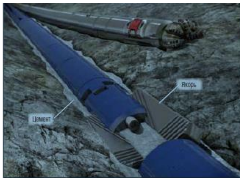
Рисунок 3.1- Зарезка бокового ствола после закачки цемента
