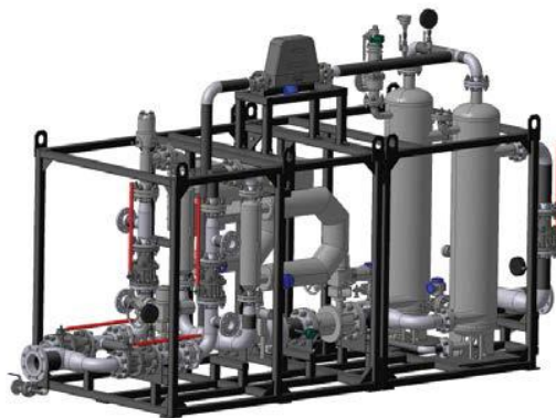
Рисунок 3.7 - Двухсепарационная установка для высокодебитных скважин
