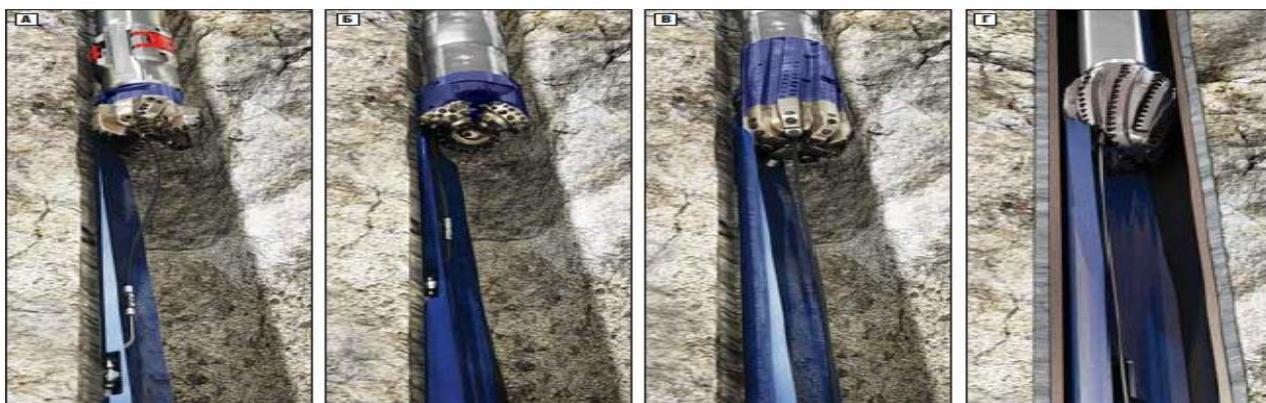
Рисунок 3.6 - Варианты использования коронок и фрез
