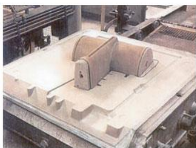
Рисунок 3.1 – Технологические операции вакуумной формовки формах из ХТС: а – обтягивание модели пленкой; б – модель обтянутая пленкой; в – полуформа с пленкой; г – полуформа для заливки; д – готовая отливка.
