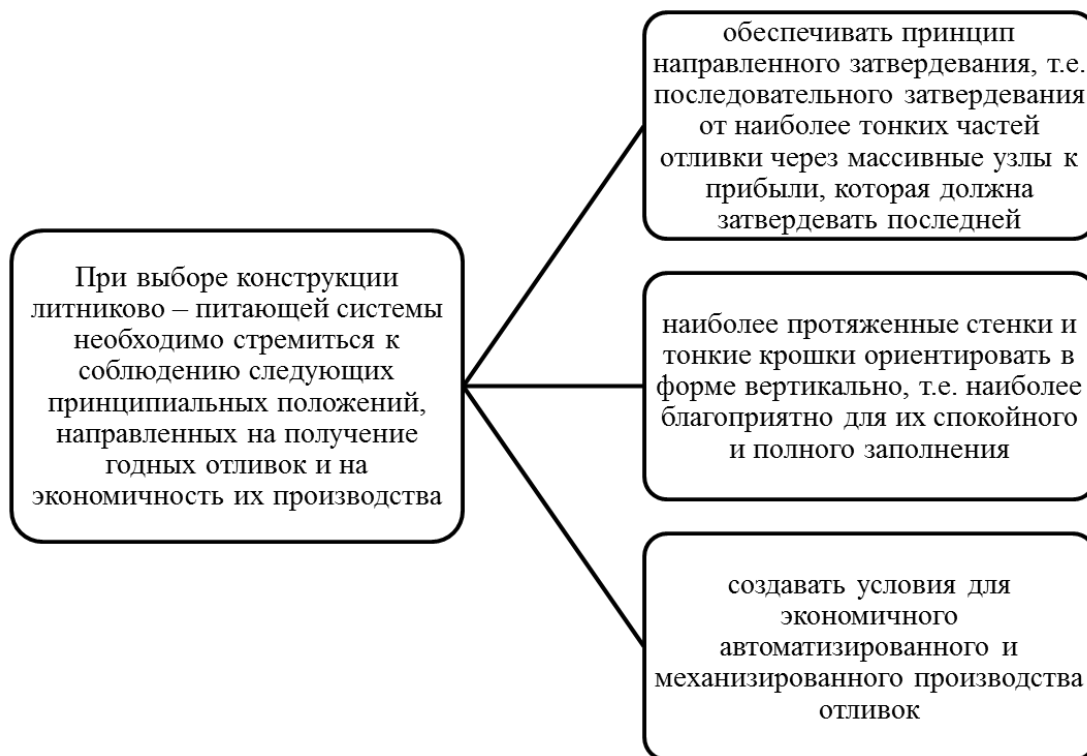
Рисунок 3.2 – Положения при выборе конструкции ЛПС
