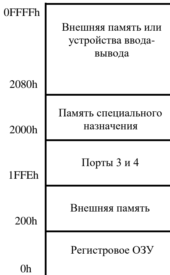
Рисунок 4.2 – Распределение адресного пространства памяти микроконтроллера
