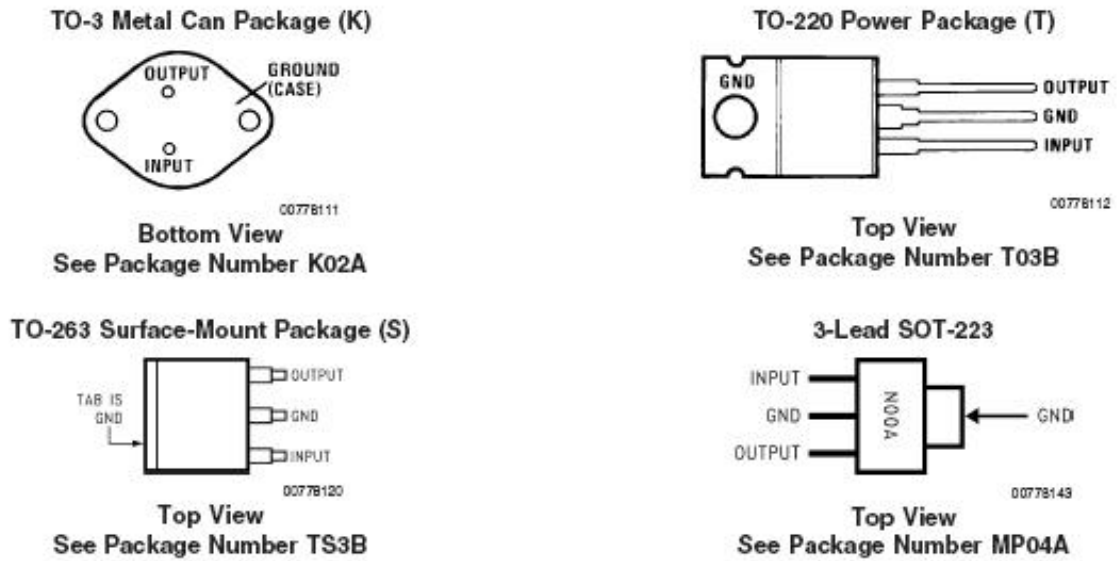
Рисунок 16 – Стабилизатор напряжения LM340AT–5.0
