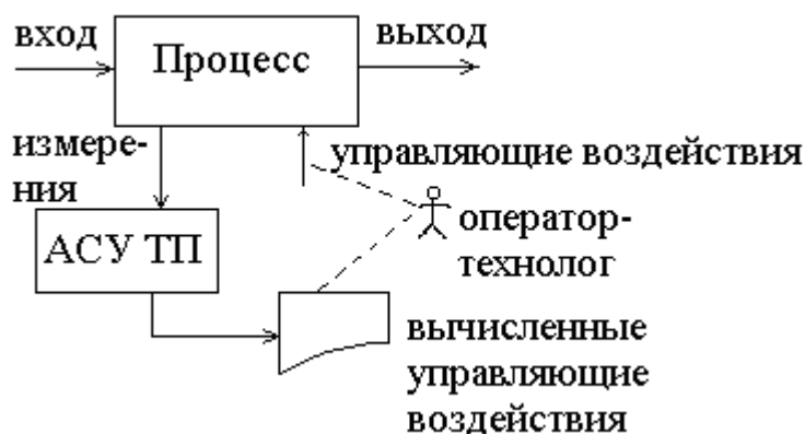
Рисунок 1.1. АСУ ТП в режиме советчика оператора
