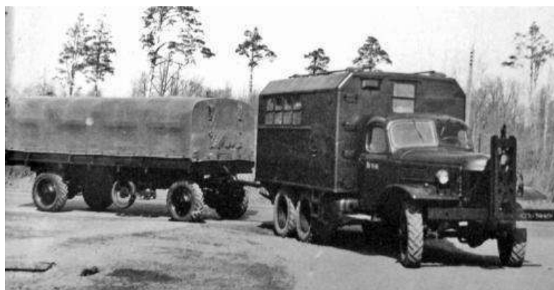
Рисунок 1.3 – Активный автопоезд в составе грузовика ЗИС-151 с генератором и прицепа с электроприводом (1959 год)
