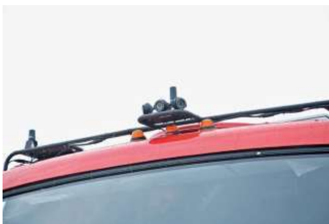
Рисунок 3.4 - Три камеры на крыше Беспилотного КамАЗа
