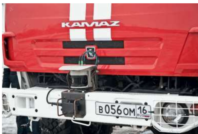
Рисунок 3.6 - Электромагнитный радар на переднем бампере грузовика
