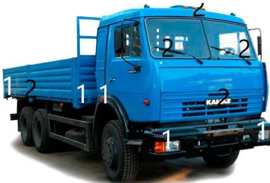
Рисунок 3.8 - Общая схема установки радаров(1) и камер (2) на автомобиле КамАЗ
