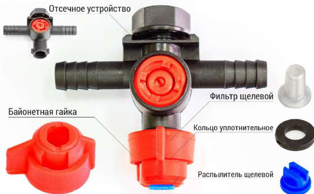
Рисунок 3.2 - Схема распылителя в сборе
