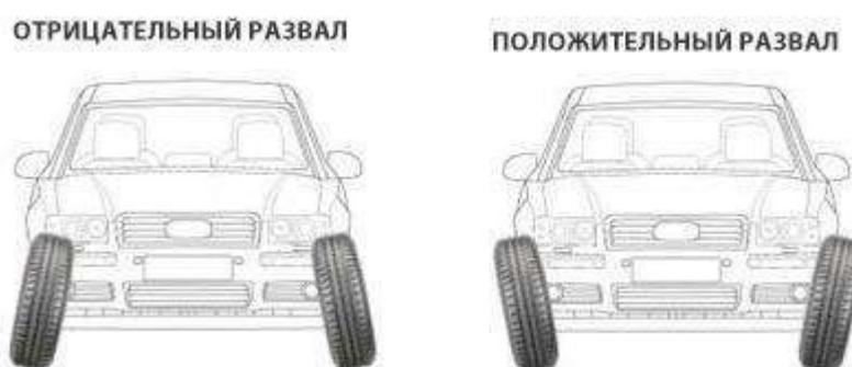
Рисунок 1.1 – Схема развал колес автомобиля
