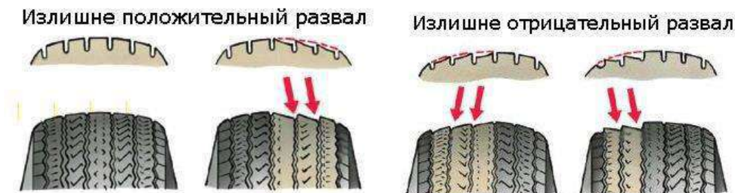
Рисунок 1.4 – Последствия неправильной регулировки развала колес
