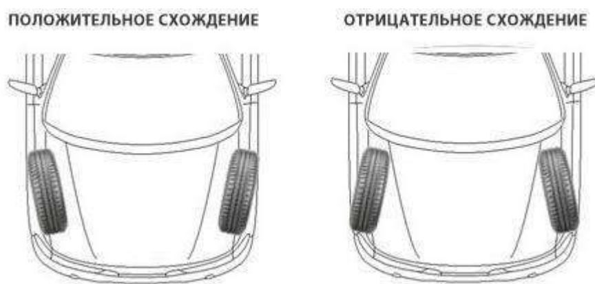
Рисунок 1.2 – Схождение колес автомобиля
