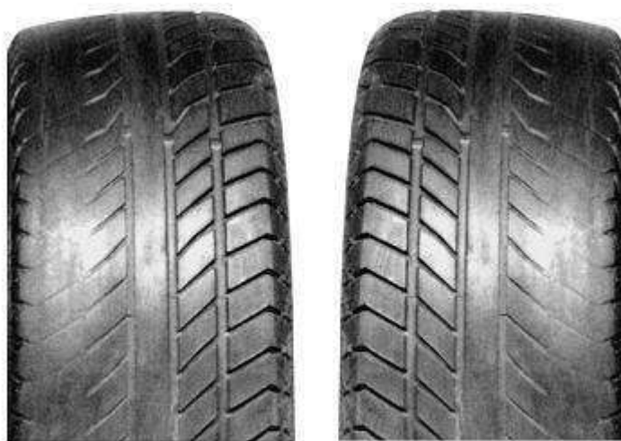
Рисунок 1.6 - Последствия неправильной регулировки углов схождения
