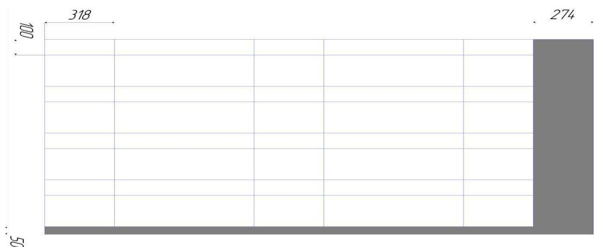
Рисунок 4.4 – Схема резки листа 2500x1250x12мм, на заготовки 318x100мм
