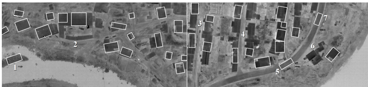
Рис. 4. Примеры работы алгоритма на аэроснимках плотной загородной застройки. Белым цветом выделены найденные строения. Цифрами 1, 5 и 7 отмечены ложные тревоги, цифрами 2, 3, 4 и 6 — пропуски
