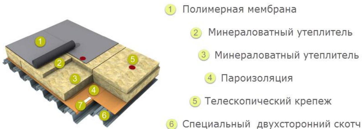
Рисунок 21 - Неэксплуатируемая кровля
