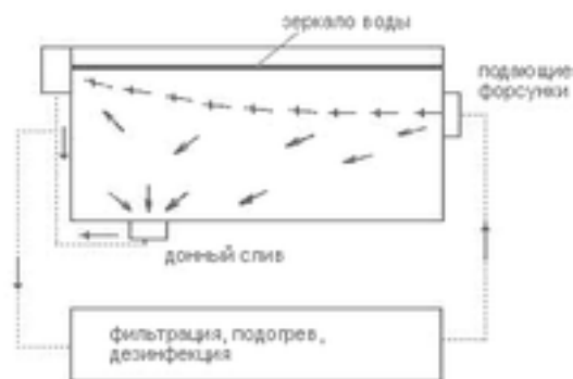
Рисунок 3.2 - Схема циркуляции воды в скиммерном бассейне
