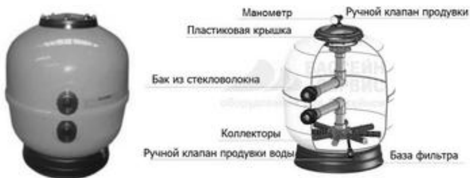
Рисунок 5.1 – Фильтровальная установка «ASTRAL» Aster FT
