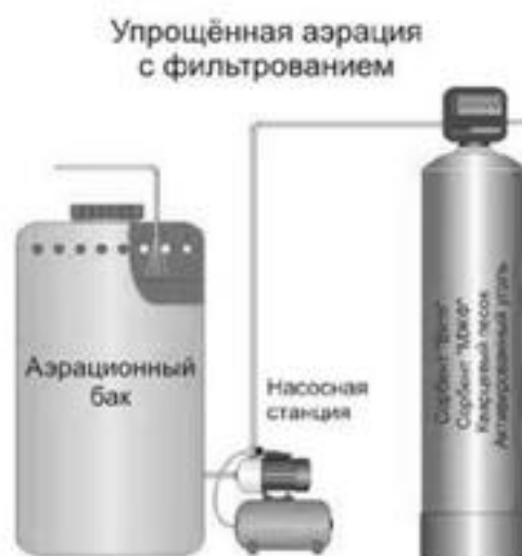
Рисунок 4.1 – Метод упрощенной аэрации с фильтрованием
