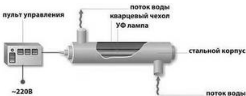
Рисунок 3.14 - Схема подключения ультрафиолетового фильтра для воды.
