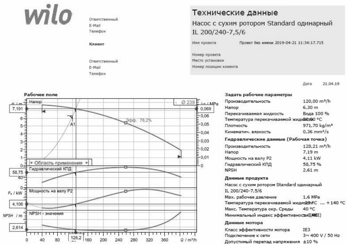
Рисунок 3.4 – Характеристика насоса WILO IL 200/240–7,5/6
