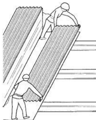
Рис.7 - Укладка стального профилированного настила на металлические балки. Технология армирования конструкций.
